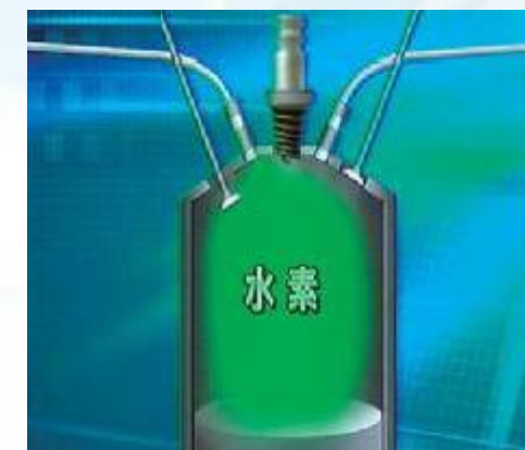
■水素【H】 高圧水素タンクから放流され、シリンダーに吹き込まれる。
