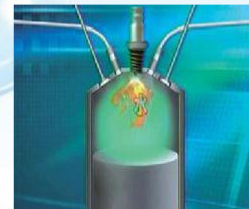
■水【W】 噴射装置で瞬間的に霧水に変えられ、直接シリンダー内に吹き込まれる。
